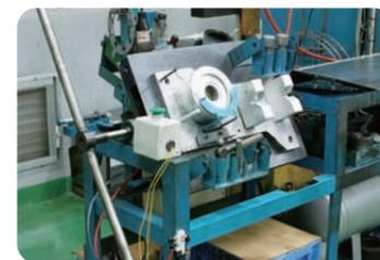
テーブルを反転させて一瞬で作業の切り替え
