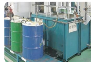
クーラントサーバーから工場中に切削液を供給します
