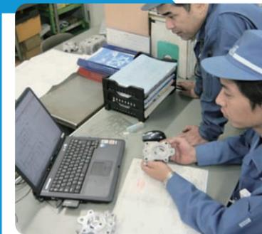
新規受注品は、技術部門で試作加工を行い、量産に耐える安定した品質と、より効率のよい加工方法を追求します。試作で練られた作り方を生産ラインへ渡し量産へと移ります。
