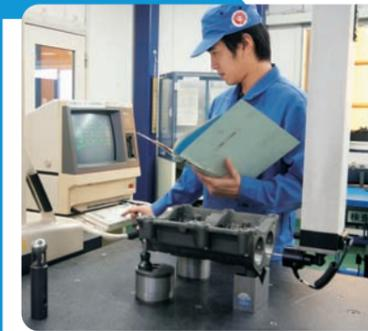
仕上がった製品を、縦・横・奥行の三方向から数値的に測定します。機械部品としての信頼に応えるため、1ミリの千分の一、ミクロン単位までの精度を追求します。
