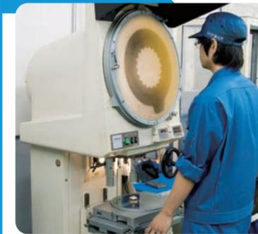
拡大レンズで小型製品をスクリーンに映し出し、角度やコーナーR、対称の精度検査を行います。デジタルカメラと人の目のダブルチェックで品質を見極めます。
