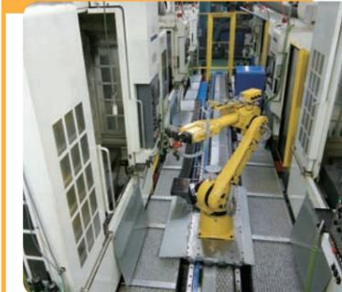
1台のロボットが6台のマシニングセンターの間に前後に走り、次々に製品を完成させていきます。高い精度と生産性を誇るオイダの新戦力です。
