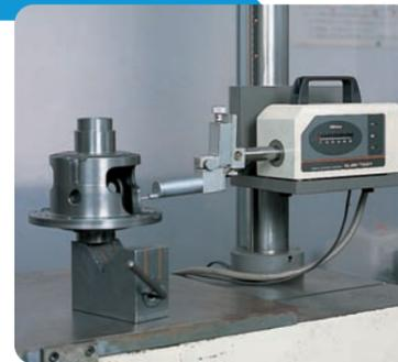
ダイヤモンドの測定子により、面削加工の終わった製品の表面の粗さを測定する精密機械です。図面通りの仕上がりは、ミクロン単位のデータ表が実証します。
